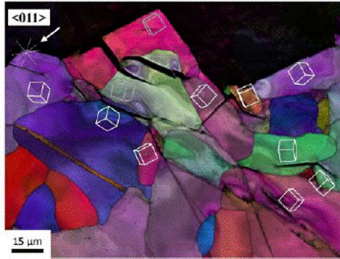
Fig. 3.1 液体窒素中で破断したアルミキルド鋼の破面直下の組織の IPF マップ[13]
