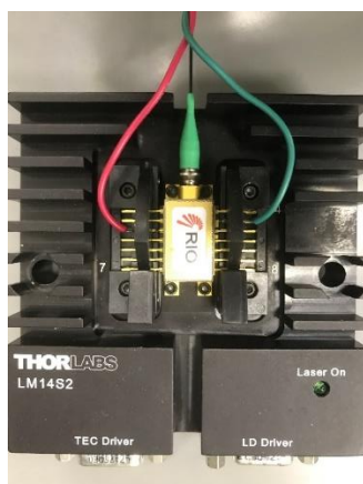
図 4.3 ECLD へのフィードバック方法. 信号線を「LD Cathode, 3 Pin」、GND 線を「LD Anode, 13 Pin」に接続している.
