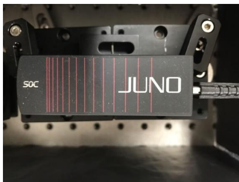
図 6.2 本研究で使用した小型固体レーザー。レーザー装置全体はレーザーヘッドとレーザーコントローラで構成されている。レーザーヘッドの大きさは 95 mm × 28 mm × 37 mm (長さ × 幅 × 高さ) である。
