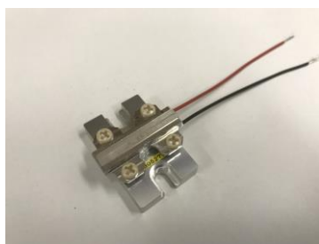
図 3.3 1542 nm レーザー光の 3 倍波発生用デュアルピッチ PPLN の写真。
