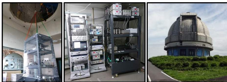
図 5.6 (左) 天文コムの光学ラックを観測スペースがある2階へと吊り上げている場面。(中央) 観測スペースで組み上げた天文コム一式。本研究で開発したヨウ素安定化レーザーは光学ラック最下段に設置されている。(右) 岡山天体物理観測所 188 cm 望遠鏡ドーム外観。
