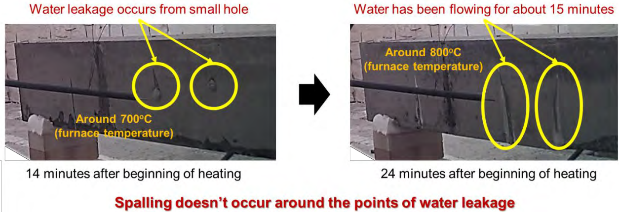
Fig. 7-1 高強度コンクリートにおける高温加熱初期の液状水の漏出
