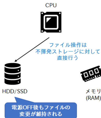
図 3.2 PC のデータ保存の仕組み
