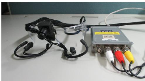
図 2.7 瞳孔径測定装置
