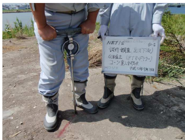
写真 5.3.2-6 現地コーン試験状況
