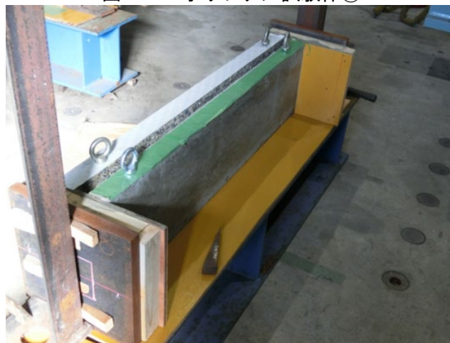
図-7.9 充填性確認試験体組立状況
