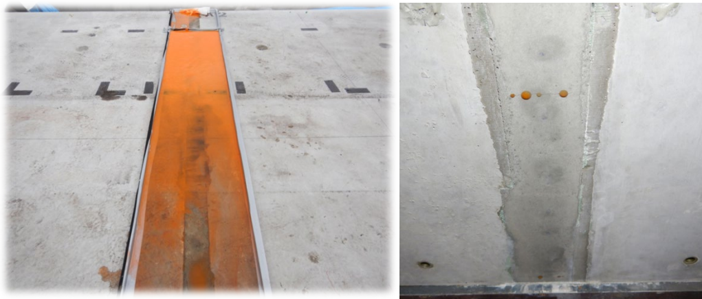
図-6.42 水貼り試験（継手-1）
