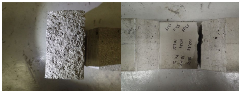
図-6.22 破断面の状況 (PCM)
