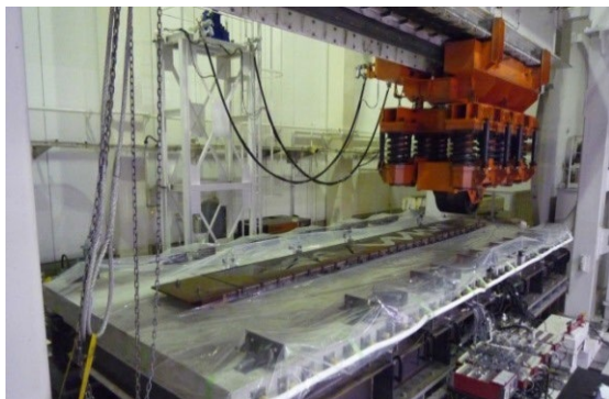
図-6.6 輪荷重走行試験機
