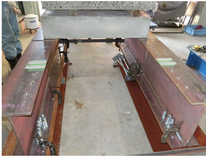
図-7.25 コンクリート床版固定用のボルト穴
