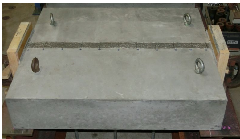
図-7.28 ひび割れ抵抗性確認試験体（充填材充填後）
