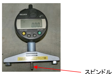
図-7.36 沈下抵抗性の測定に使用したデブスケージ
