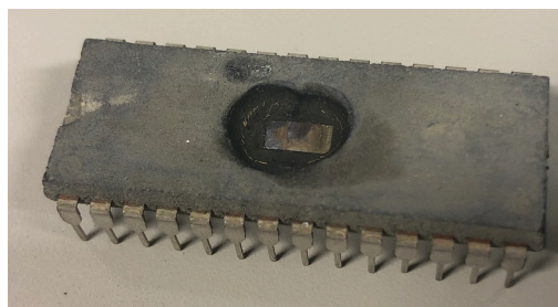
図 3.11: DIP パッケージの上面を薬品で開封
