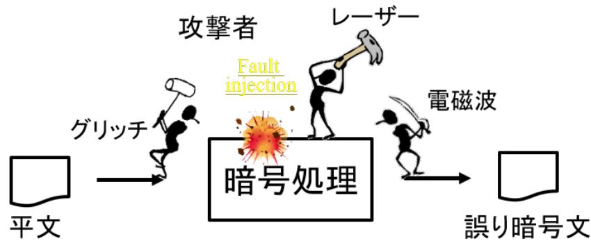
図 1.4: フォールト攻撃の概要図. 攻撃者は暗号処理が実装されたハードウェアに意図的な計算誤り (フォールト) を注入することで誤り暗号文を取得し, 誤り暗号文から秘密情報を特定できる.
