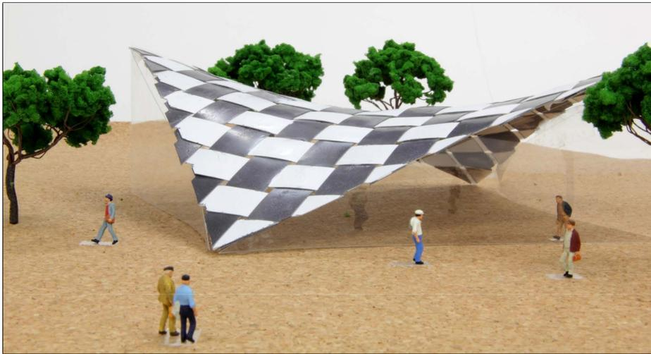
図 6.23: プラスチック板によるストリップの編み込み成形 ([20] からの転載). プラスチック板で表現されている双曲線放物面は建築物設計に使用される.
