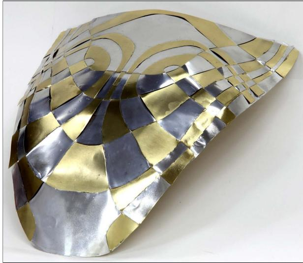
図 6.24: シートメタルによる展開ストリップの編込み成形 ([20] からの転載). 展開ストリップにシートメタル適用して自動車フード曲面が成形されている.
