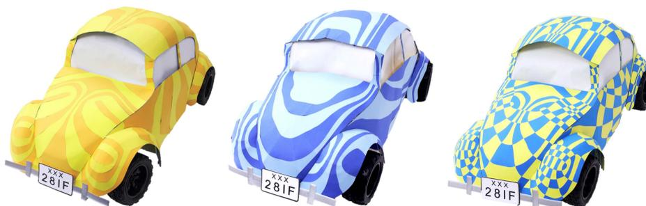
図 6.22: 自動車モデルの成形 ([20] からの転載). 左から右: 展開ストリップによる 2 層成形 (表側が最大主曲率ストリップ). 展開ストリップによる二層成形 (表側が最小主曲率ストリップ). 編込み成形.
