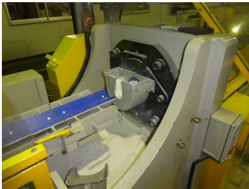
写真 1 ドローベンチ試験装置（藤岡工作所製）
