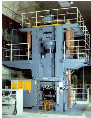
写真 1 4.9MN 油圧プレス外観写真
