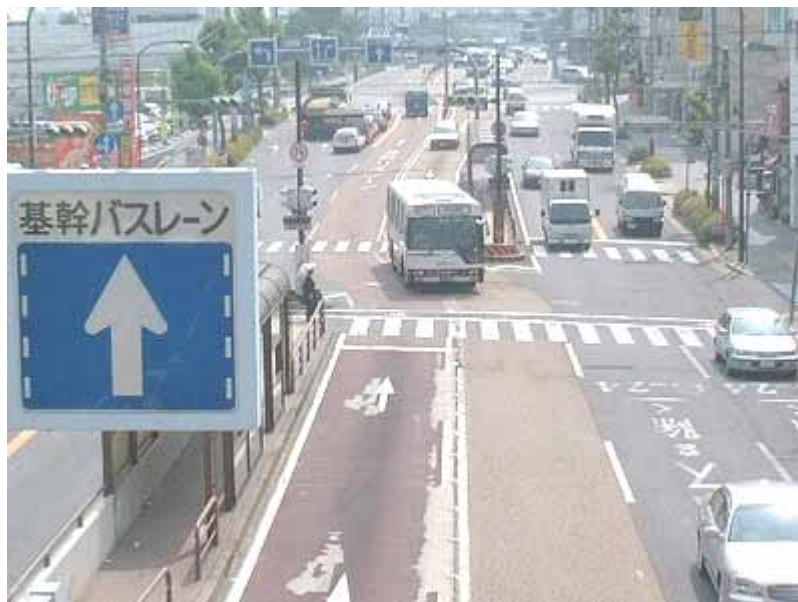
図 3-8 中央走行バス専用レーンの例（基幹バス，名古屋）
