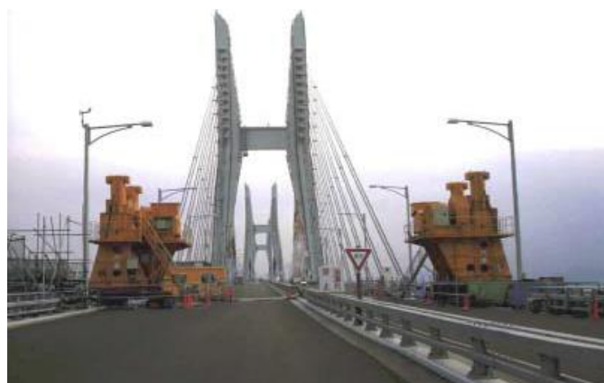
図- 3. 2. 1 振動試験状況(石島橋) [3. 4]
