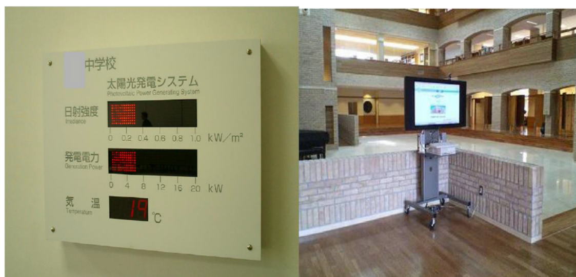
図 3.1 発電量モニタ外観 (左 : ①富山県 H 中、右 : ②東京都 D 中)
