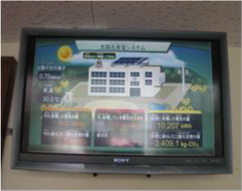
図 4.4 発電量モニタの外観（横浜市 K 小）
