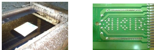
図 2.18 はんだ耐熱試験槽とテストパターン
