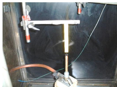
図 4.8 バーナーと試験片
