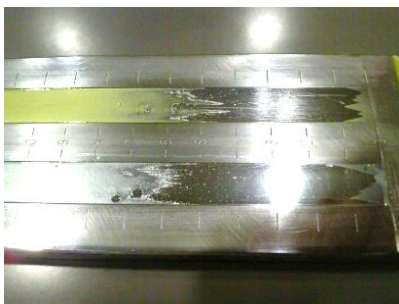
(c)未硬化部分から硬化膜を剥がし硬化界面の数値を読み取る
