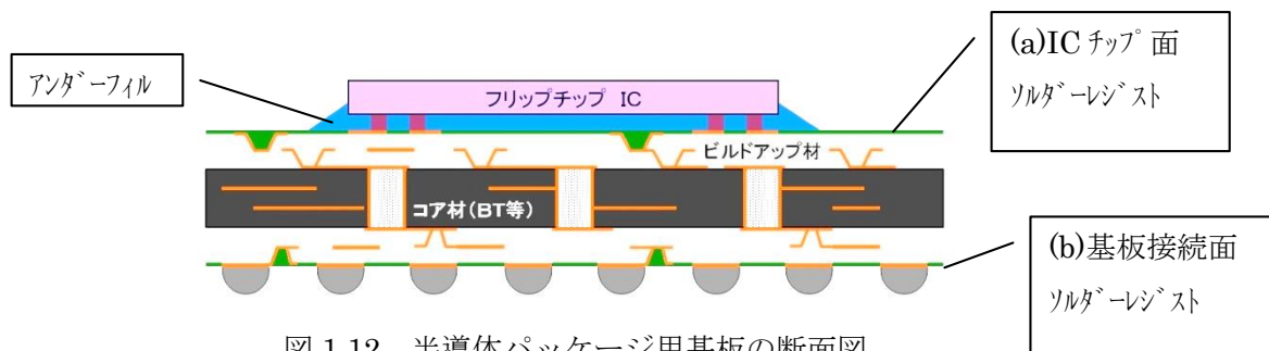
図 1.12 半導体パッケージ用基板の断面図
