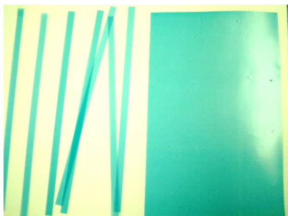
測定試料（膜厚 50 \mu m × 幅 2.5mm × 長さ 75mm）
