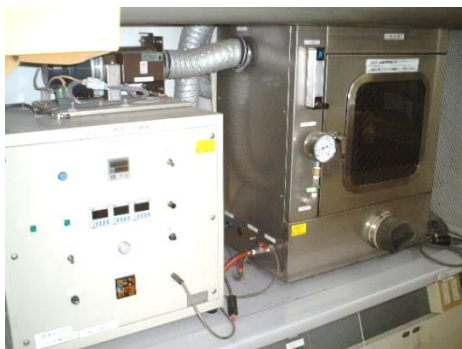
図 4.7 難燃性試験の燃焼箱
