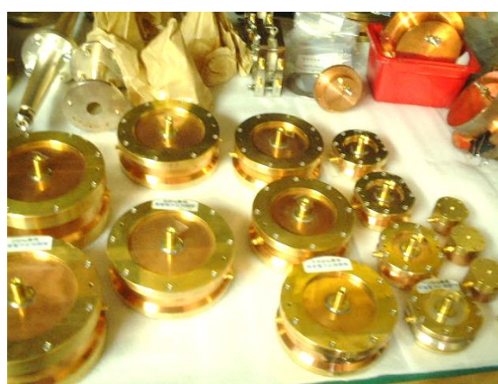
空洞共振器 5GHz 10GHz 20GHz
